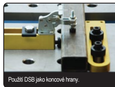
Odpružený doraz poskytuje variabilní tlak na obrobek.
