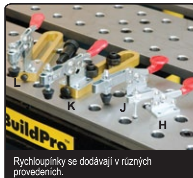
Rychloupínky Good Hand® lze namontovat na všechny typy DSB.
